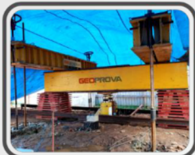
Prova de carga estática em estacas (PCE)
