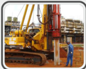
Ensaio de carregamento dinâmico (PDA)
