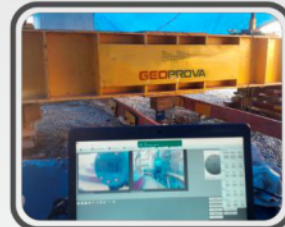
Prova de carga estática direta - em placa
